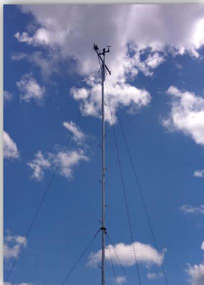
Arah dan Kecepatan angin diukur menggunakan Anemometer. Arah angin diukur dengan satuan derajat “ $^{\circ}$ ” sedangkan kecepatan angin diukur dalam satuan “knot”.
