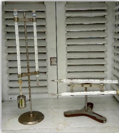
Suhu Udara Permukaan diukur menggunakan termometer dengan satuan “ °C “. Termometer di Stasiun Meteorologi H. Asan Kotawaringin Timur terdiri dari termometer bola kering, bola basah, maksimum, dan minimum.
