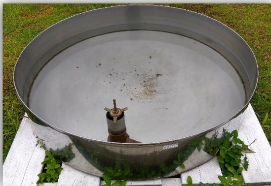
Penguapan diukur menggunakan *Evaporimeter* dengan satuan “ milimeter “. *Evaporimeter* di Stasiun Meteorologi H. Asan Kotawaringin Timur adalah jenis *Open Pan Evaporimeter* (Panci Penguapan Terbuka)
